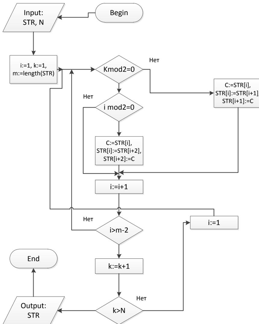
**Рис. 1.** Блок схема алгоритма обработки строки  $STR$
